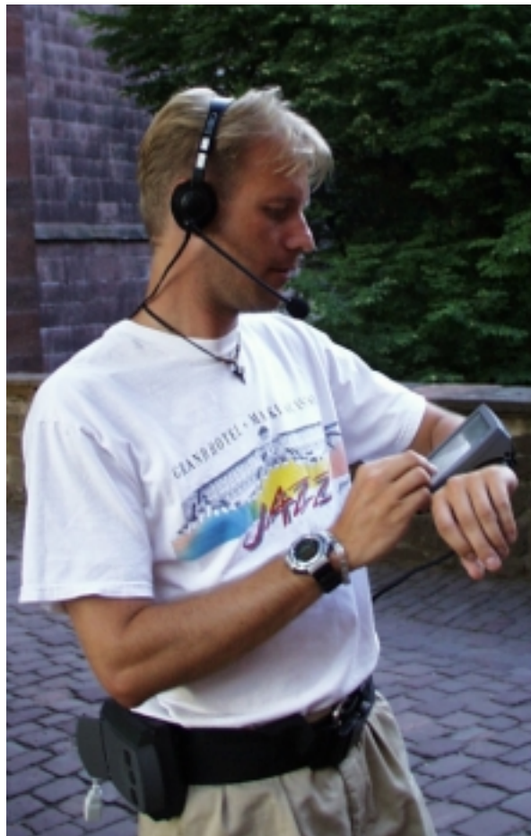
Abb. 4: mobile Variante des Deep Map Systems auf dem wearable PC MA IV der Fa. Xybernaut
